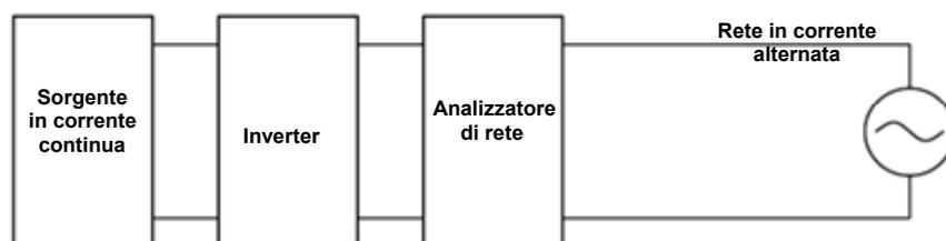
NOTA Questo circuito di prova si applica ai sistemi monofase. Per sistemi trifase si dovrà prevedere un circuito equivalente di tipo trifase.
