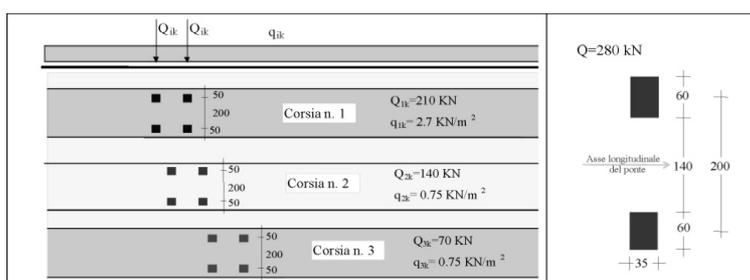
Fig. 5.1.4 - Modello di carico di fatica 1
