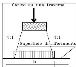
Fig. 5.2.4 - Distribuzione longitudinale dei carichi attraverso il ballast
