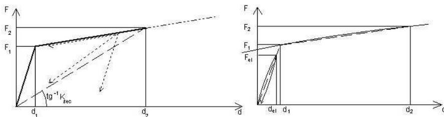
Fig. 11.9.1 - Diagrammi forza – spostamento per dispositivi non lineari
