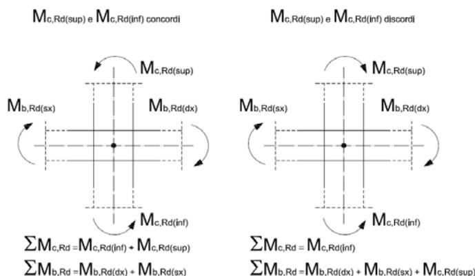
Fig. 7.4.2 – Progettazione in capacità dei pilastri
