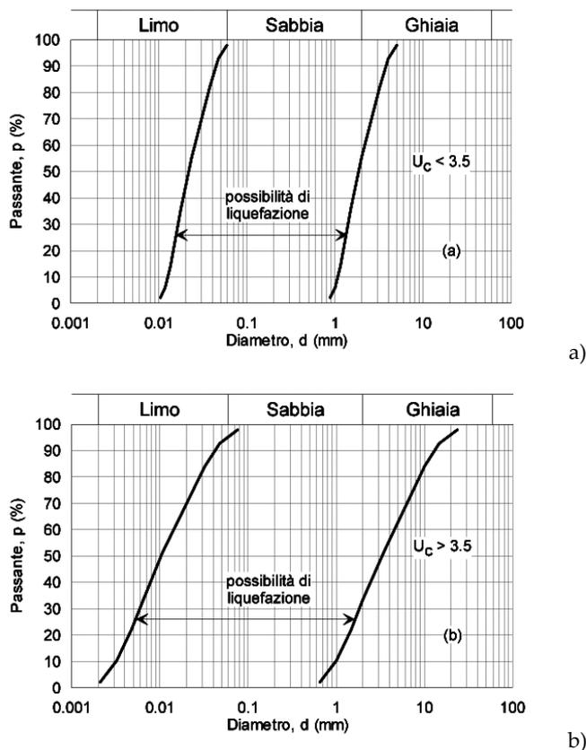
Fig. 7.11.1 – Fusi granulometrici di terreni suscettibili di liquefazione
