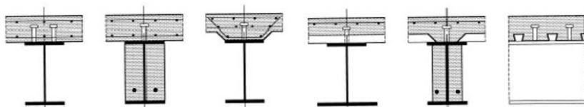
Fig. 4.3.3 -Tipologie di sezione composte per travi
