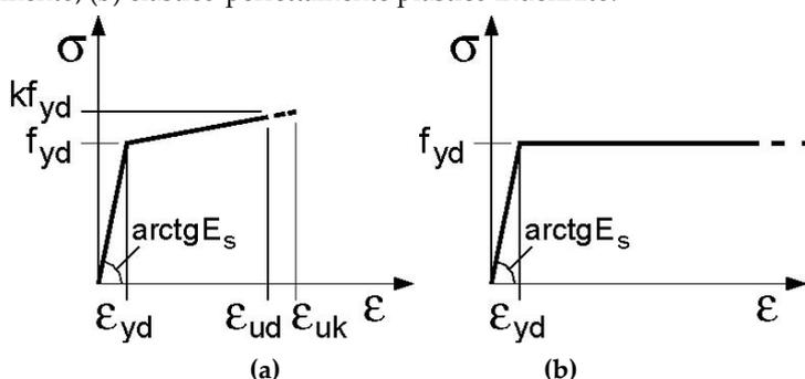
Fig. 4.1.3 – Modelli  $\sigma$ - $\varepsilon$  per l'acciaio
