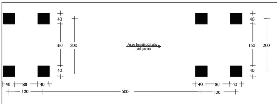
Fig. 5.1.5 - Modello di carico di fatica. 3
