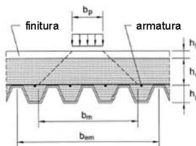
Fig. 4.3.12 - Diffusione del carico concentrato
