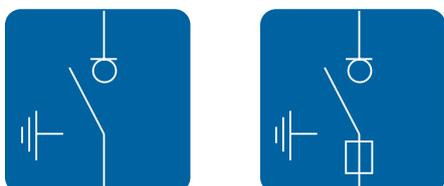
Figura 5.13: UF Interruttore (in esecuzione fissa, asportabile ed estraibile)
