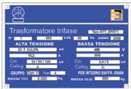
Figura 4.2: Targa di un trasformatore
