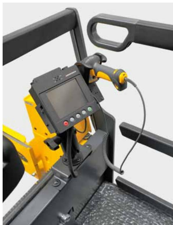
EKX 515 con terminale di radiotrasmissione e scanner, montato alla ringhiera
