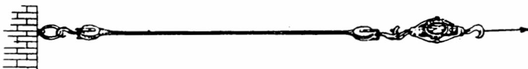
Le corde in fibre vegetali sono più deboli rispetto a quelle artificiali. Una volta bagnate, le corde in fibre vegetali perdono circa il 50% della loro resistenza e hanno un rapporto resistenza-peso molto limitato. Una maggiore resistenza è ottenibile ricorrendo a funi di diametri maggiori. Il loro **uso nel soccorso è attualmente limitato**.
