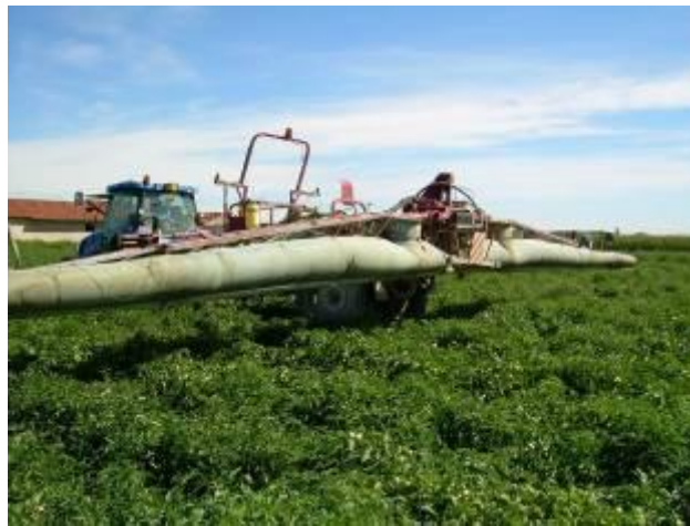
Figura 7 Barra irroratrice con manica d'aria.
