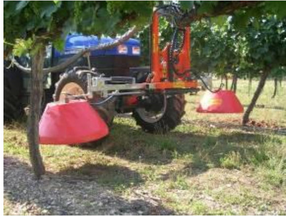
Figura 9 Attrezzatura per il diserbo del sottofila del vigneto dotata di sistemi di schermatura degli ugelli.
