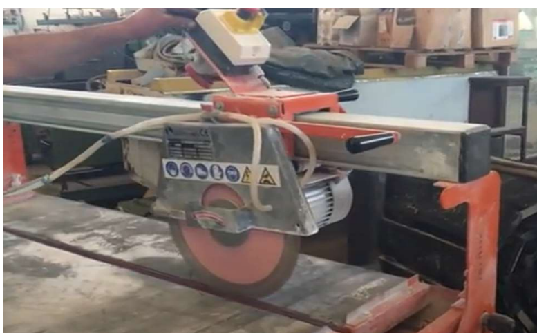
Figura 3b. Esempio di taglierina ad acqua con elemento da tagliare bloccato sul piano di taglio e carro di supporto della troncatrice, mobile su slitta.
