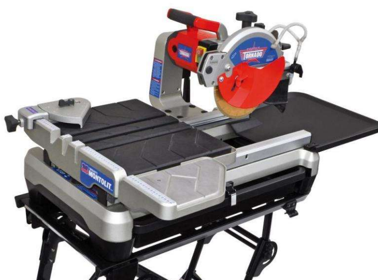
Figura 3a. Esempio di taglierina ad acqua con elemento da tagliare su carro di supporto mobile su slitta e troncatrice bloccata.
