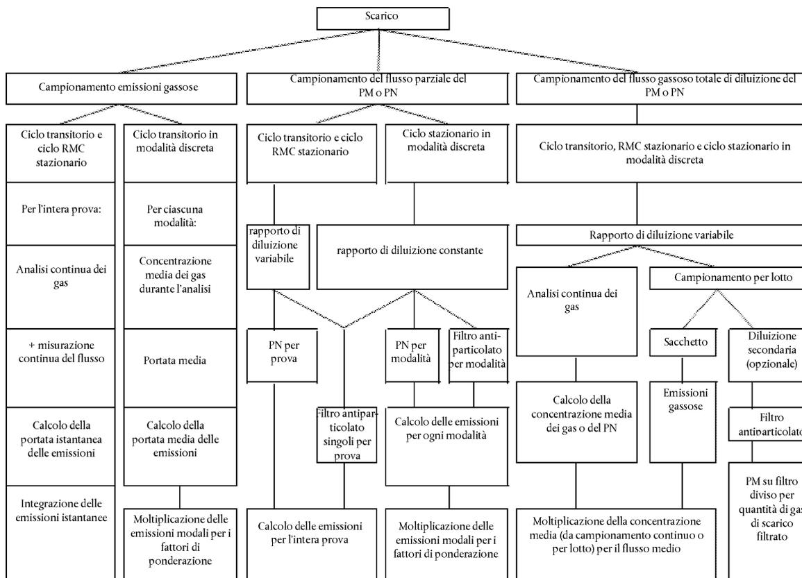
Nota alla figura 6.2: il termine «campionamento del PM a flusso parziale» comprende la diluizione a flusso parziale per estrarre solo gas di scarico grezzi con un rapporto di diluizione costante o variabile.
