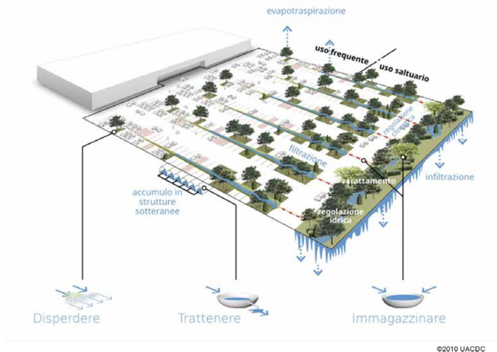
Figura 10: esempio di compartimentazione di un parcheggio in base alla frequenza di utilizzo e l'intensità e tipologia di soluzioni di invarianza (modificato da UACDC, 2010)
