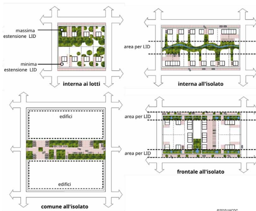
Figura 6: diverse dislocazioni dei dispositivi di invarianza all'interno del lotto/isolato e combinazione di dispositivi (modificato da UACDC, 2010)
