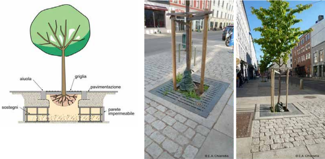
Figura 26: a sinistra schema di aiuola drenante equipaggiata con alberatura (modificato da City of Edmonton 2014); a destra esempi ad Oslo, Norvegia.
