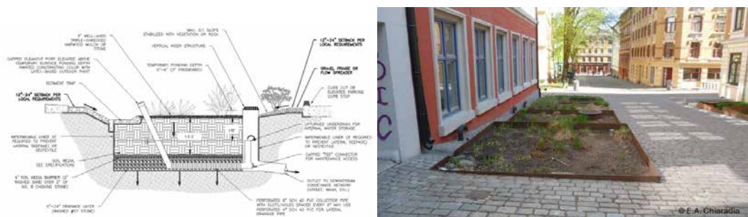
Figura 23: a sinistra schema costruttivo di aiuola di bioritenzione (da City of Tucson, 2015); a destra Oslo, Norvegia (foto Chiaradia)
