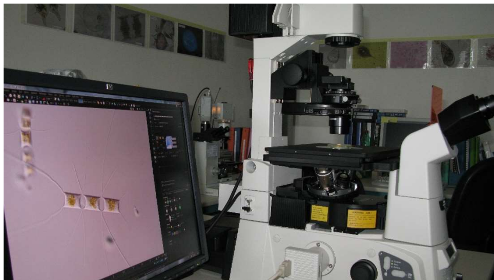
Figura 5.8 – Microscopio Nikon Eclipse Ti utilizzato per l'identificazione ed il conteggio delle microalghe
