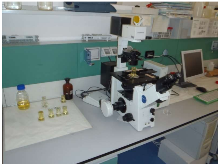
Fig 13.4 - microscopio ottico invertito e camere di sedimentazione
