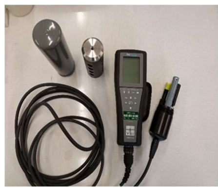
Fig 6.2 - Sonda multiparametrica portatile YSI ProQuatro
