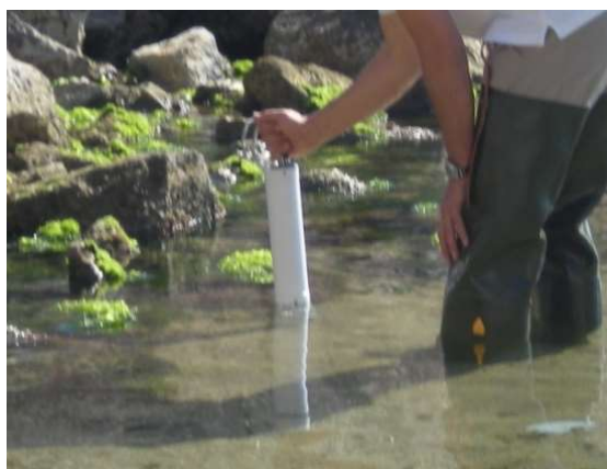
Fig 13.3 - misura dei parametri chimico-fisici con sonda multiparametrica
