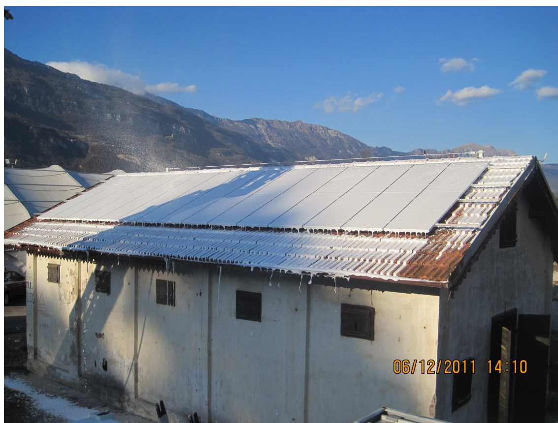
Figura 5-6: prova con CAFS: schiumaggio completato
