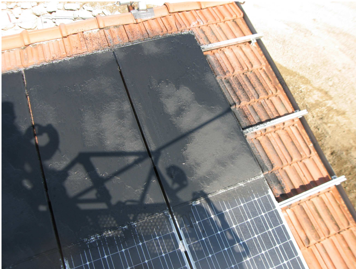
Figura 5-33: prova con gel Prevento Solar: particolare del gel posato sui pannelli
