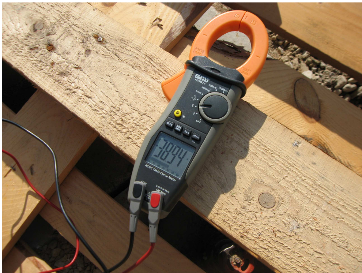
Figura 5-36: prova con gel Prevento Solar su pannello Sunpower: tensione finale
