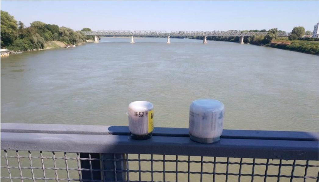
Grazie alla batteria al litio, i tracciatori hanno potenzialmente una vita operativa autonoma che varia dai 18 ai 48 mesi, a seconda delle scelte di programmazione, in qualsiasi condizione ambientale.
