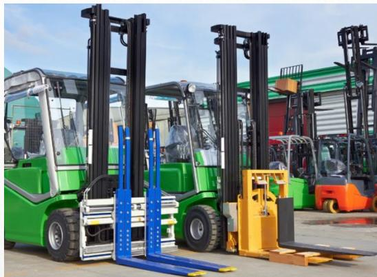
Il **montante Simplex** è composto da uno stadio fissato al telaio del carrello e dalla piastra porta forche che scorre nel suo interno.
