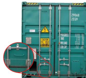
Figura 8.4 Peldaños de un contenedor de carga a granel
