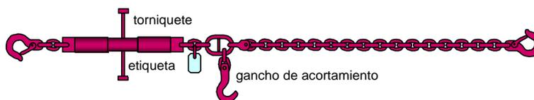
Figura 7.18 Cadena de trinca normalizada con gancho de acortamiento
