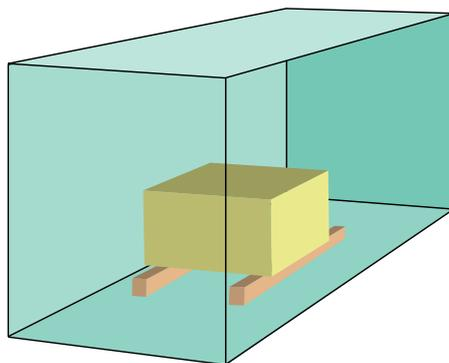
Figura 7.21 Vigas de transferencia de la carga
