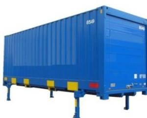
Figura 5.6 Caja amovible sobre sus patas de apoyo
