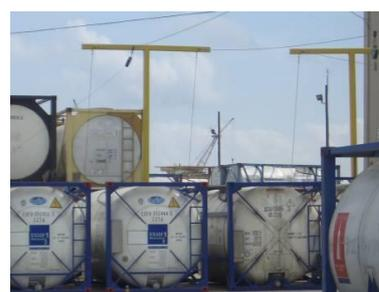
Figura 8.12 Soportes para detener las caídas
