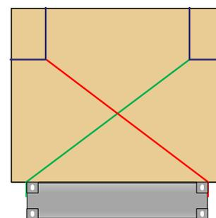
Figura 7.48 Sujeción transversal con trincas por resorte
