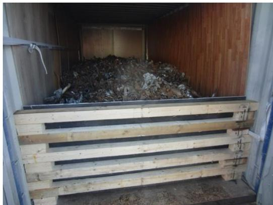
Figura 7.55 Unidad de transporte con paredes revestidas y una barrera de puerta con chatarra
