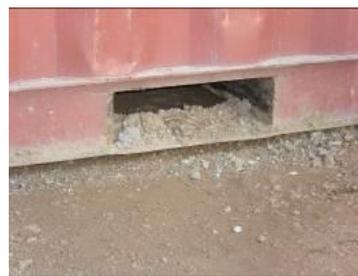
Figura 6.3 Lodo en abertura para la horquilla
