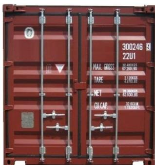
**Figura 4.7 Extremo posterior del contenedor**
