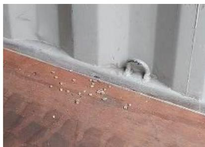
Figura 6.4 Residuos de cargas anteriores
