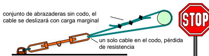
Figura 7.15 Conjunto inadecuado para trincado con cable metálico
