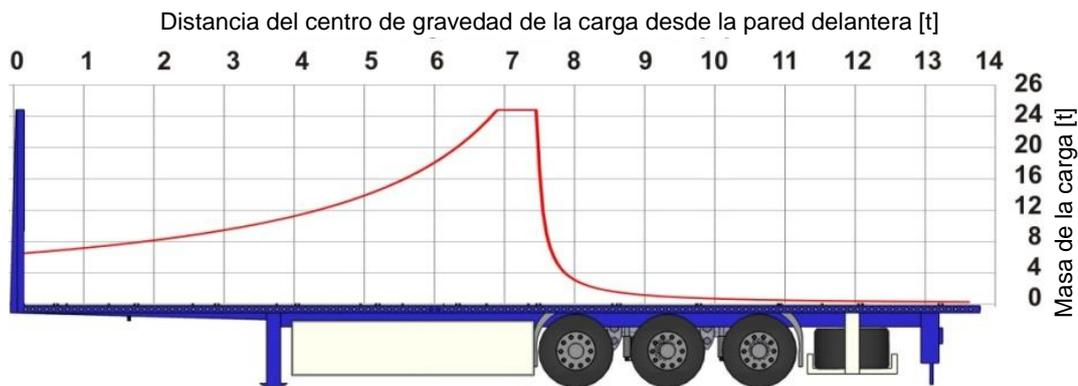
Figura 7.23 Ejemplo de un diagrama de distribución de la carga de un semirremolque
