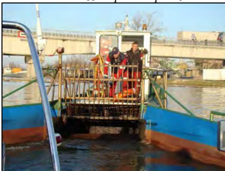
Figura 1.9 - Natante attrezzato per l'aspirazione di idrocarburi
