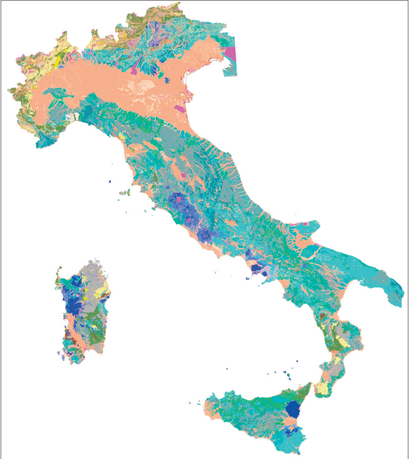
Fig. 1 - La carta mostrata in figura rappresenta l'applicazione della legenda litologica descritta nel testo sul territorio nazionale. La scala originale è 1:100.000. Nonostante alcuni evidenti limiti legati al rilevamento geologico originale ed alle differenti interpretazioni per fogli contigui rilevati anche a 100 anni di distanza l'uno dall'altro, si riscontra un notevole miglioramento nella omogeneità di rappresentazione.
