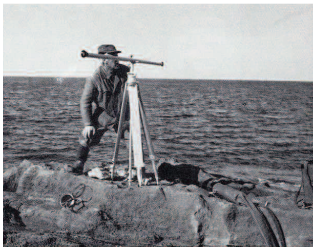
Fig. 34 - Una delle stazioni di posizionamento nave da terra col metodo della triangolazione con teodolite. - Vessel positioning station from the ground with the theodolite triangulation method.
