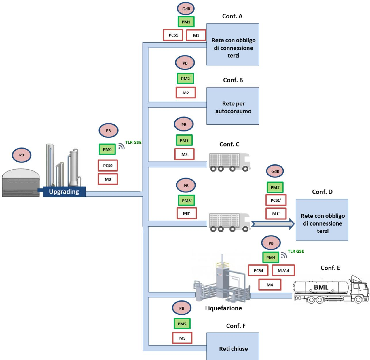
Figura 7 – Impianto di produzione di biometano in configurazione multipla.
