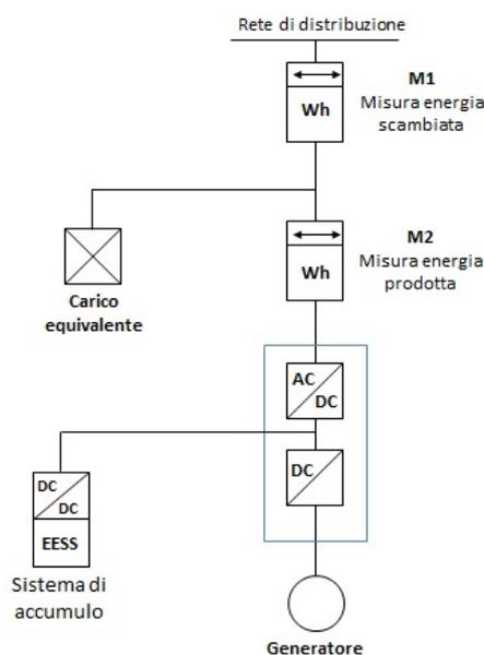
**Figura 2:** Misura dei flussi di energia con accumulo posizionato nella parte d'impianto in corrente alternata a valle del contatore dell'energia generata
