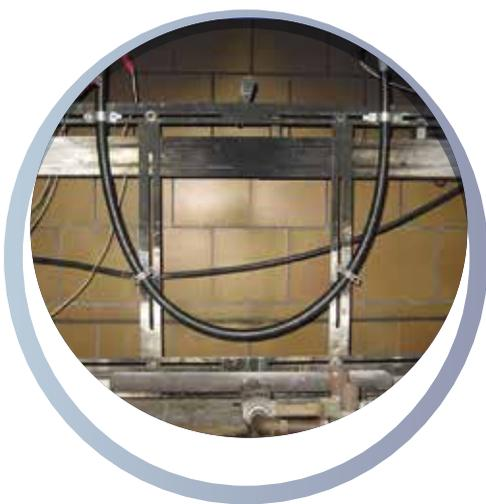
La Norma specifica il metodo di prova per i cavi che devono mantenere l'integrità del circuito se soggetti a incendi e shock meccanici in determinate condizioni. Il metodo è applicabile a cavi di diametro superiore a 20 mm con tensione nominale non superiore a 600 V/1000 V, compresi quelli con tensione nominale inferiore a 80 V, cavi per comunicazione elettronica con conduttori metallici e in fibra ottica.
