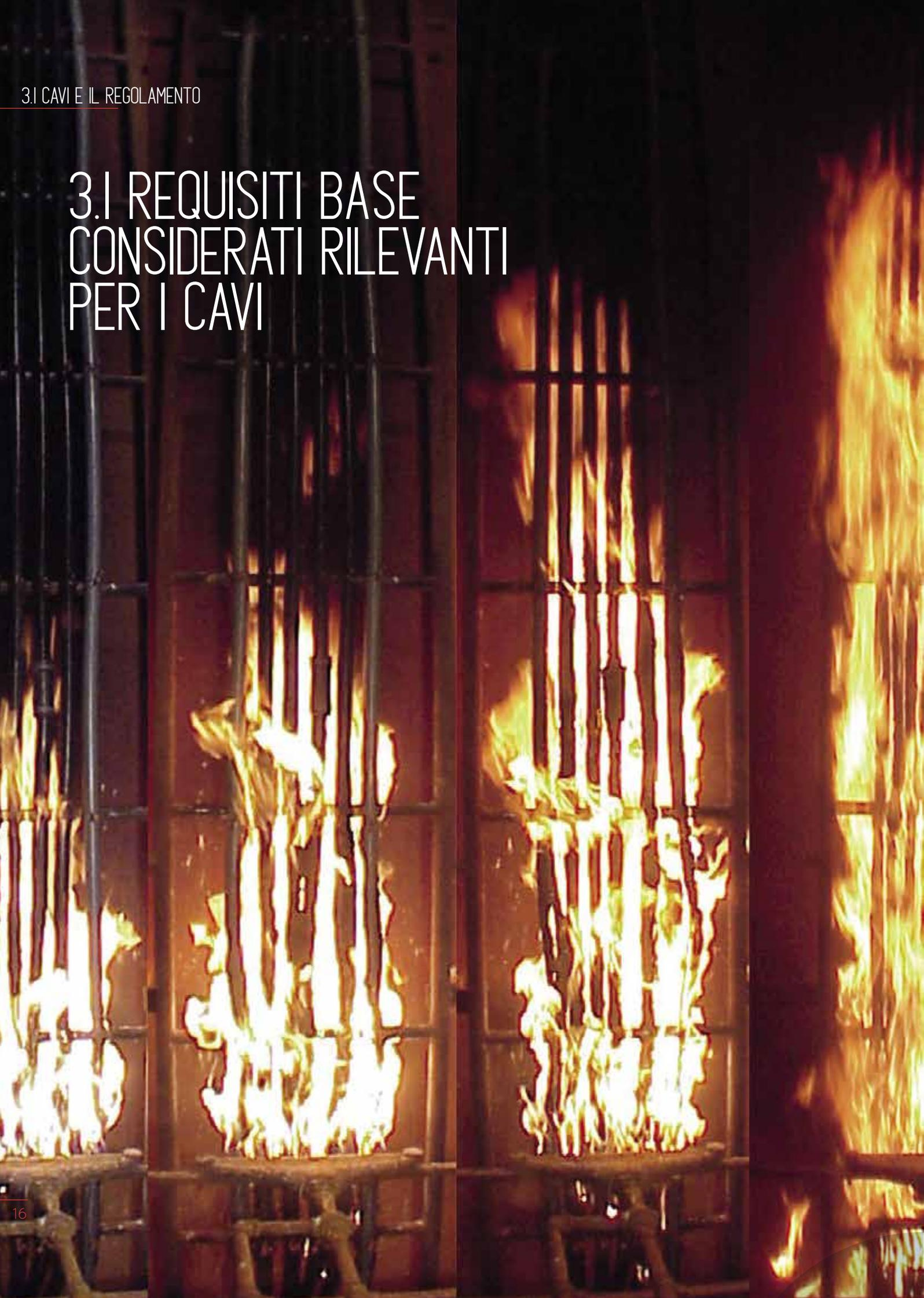
I cavi elettrici sono raramente la causa di un incendio ma quando vi sono coinvolti possono costituire elemento di grave pericolo, causandone la sua propagazione, in ragione della loro elevata quantità e della loro diffusione in tutti gli ambienti dell'edificio.
