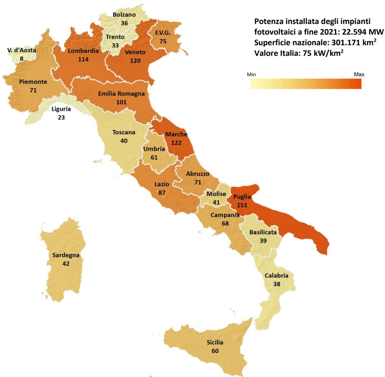
L'incremento di potenza installata rilevato nel 2021 ha portato il dato medio nazionale a 75 kW per km<sup>2</sup>. Le regioni che si attestano al di sopra dei 100 kW per km<sup>2</sup> sono la Puglia, con 151 kW, le Marche con 122 kW, il Veneto con 120 kW e la Lombardia con 114 kW.
