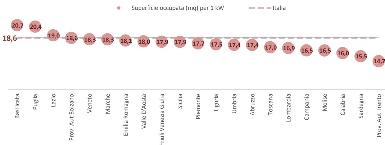
Analizzando la densità di occupazione di suolo degli impianti installati a terra è possibile osservare una variabilità regionale contenuta. La superficie lorda media a livello nazionale è pari a circa 18,6 m<sup>2</sup>/kW, con un valore massimo di 20,7 m<sup>2</sup>/kW osservato in Basilicata e un valore minimo di 14,7 m<sup>2</sup>/kW osservato nella Provincia di Trento.
