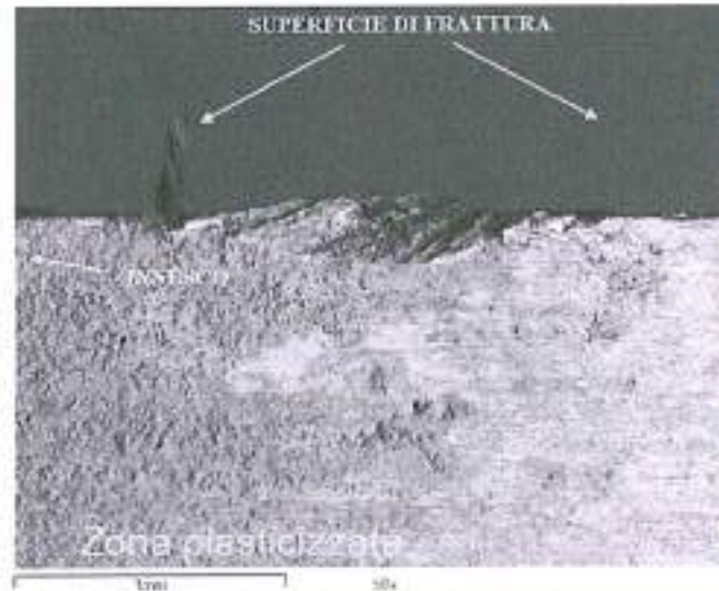
Particolare della superficie del raccordo
