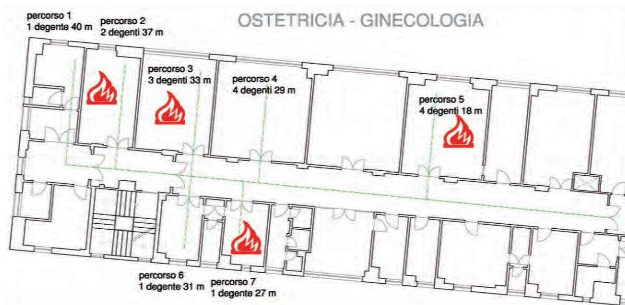
ESEMPIO SCENARI DI INCENDIO E PERCORSI DI ESODO DAL REPARTO AL PIANO TERZO - EDIFICIO A
