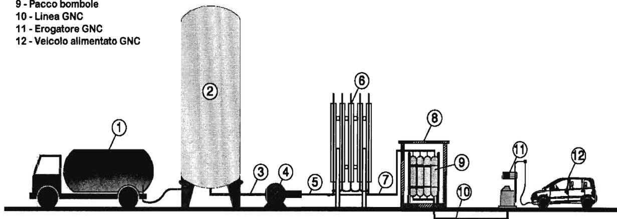
La guida tecnica si occupa dell'impianto di alimentazione GNL a servizio di un impianto di distribuzione GNC per autotrazione, quindi sino ai recipienti di accumulo (punto 8) che sono normati al punto 2.5 "Locale recipienti di accumulo" del D.M. 28/6/2002.
