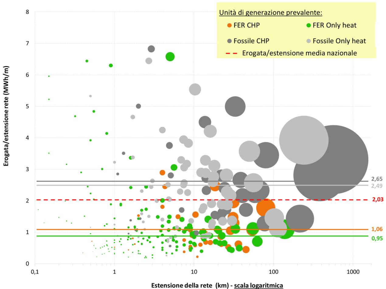
La densità termica lineare di una rete di teleriscaldamento è un indicatore composto dal rapporto tra energia erogata ed estensione della rete e può essere utilizzato per valutare la sostenibilità economica di una rete di teleriscaldamento. Questo parametro dipende sia dalle caratteristiche urbanistiche del centro abitato servito sia dalla sua domanda termica specifica da teleriscaldare e varia negli anni al variare dell'estensione della rete e delle utenze allacciate sulla rete esistente.
