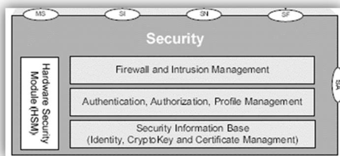
Figura 19 - Funzioni di dettaglio del Security Layer
