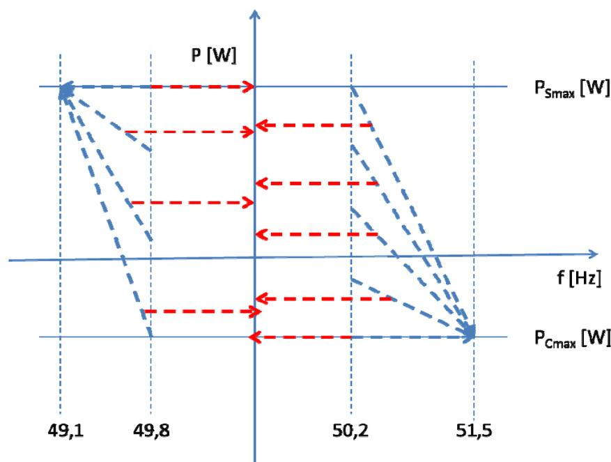
Figura 14-b. – Rientro da condizioni di sovra e sottofrequenza
