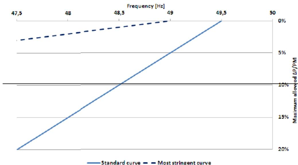
**Figura 12bis – Riduzione ammessa della massima potenza attiva erogabile in regime di sottofrequenza**
