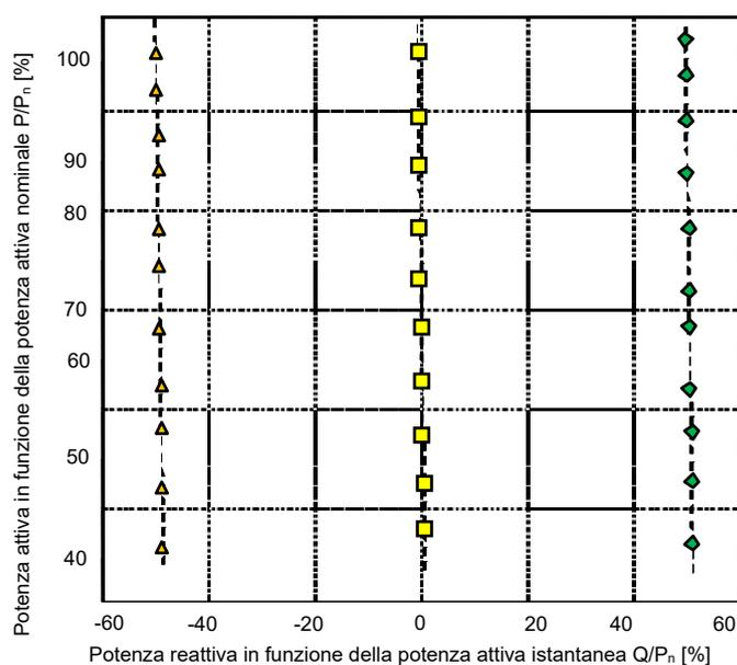
**Figura 24 – Esempio di Grafico  $P(Q)$ . Massima potenza reattiva induttiva e capacitiva erogata in funzione della potenza attiva (qui è rappresentato il caso di un inverter di potenza superiore a 11,08kW, che deve poter assorbire o erogare a qualsiasi livello di potenza attiva una potenza reattiva pari almeno al 48,43 % della potenza attiva nominale,  $Q_{\min}/P_n = 48,43 \% P_n$ )**
