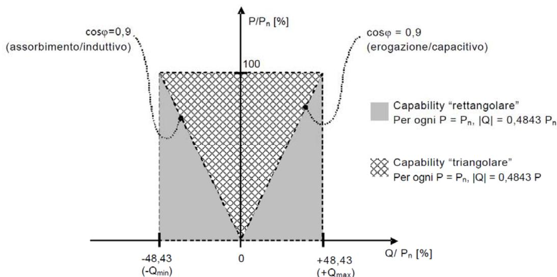
Figura 13 – Curve di capability “triangolare” e “rettangolare”
