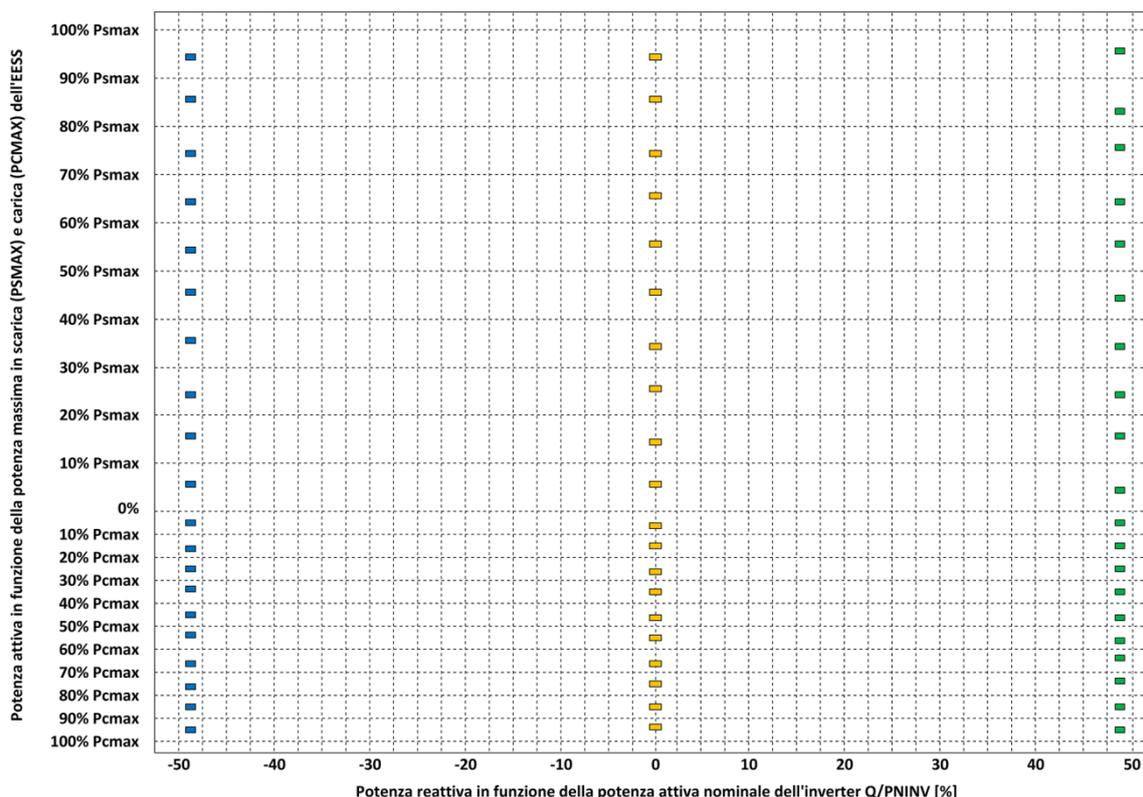
**Figura 5Bbis – Esempio di Grafico P(Q). Massima potenza reattiva induttiva e capacitiva erogata in funzione della potenza attiva (qui è rappresentato il caso di sistema di accumulo di potenza superiore a 11,08 kW, che deve poter assorbire o erogare a qualsiasi livello di potenza attiva una potenza reattiva pari almeno al 48,43% della potenza attiva nominale,  $Q_{min}/P_n = 48,43\% P_n$ )**
