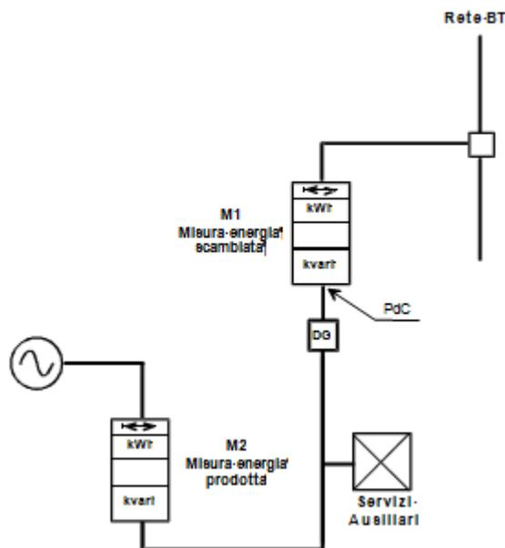
**Figura 19 – Schema di collegamento dei sistemi di misura per i punti di immissione riferiti a impianti di produzione per i quali l'energia elettrica immessa non coincide con l'energia elettrica prodotta**
