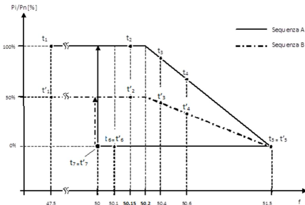
**Figura 10Bbis – Curve di limitazione della potenza attiva per convertitori unidirezionali**
