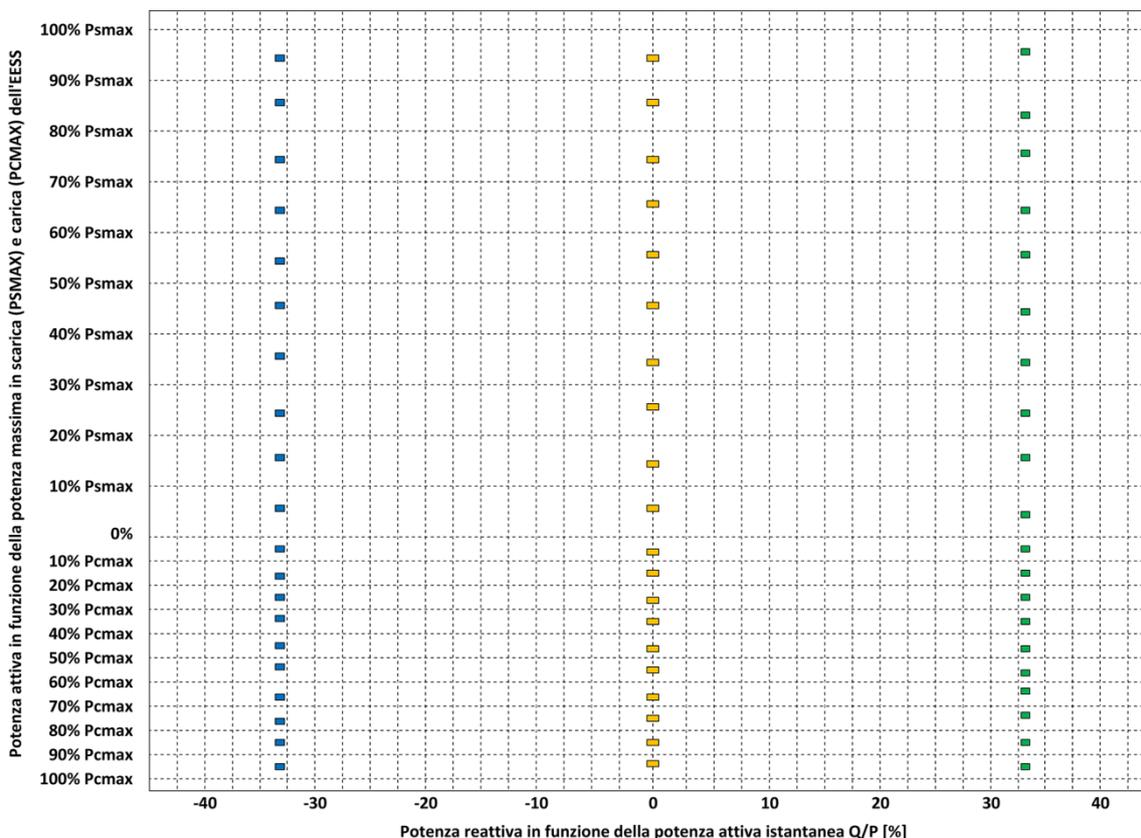
**Figura 4Bbis – Esempio di Grafico P(Q). Massima potenza reattiva induttiva e capacitiva erogata in funzione della potenza attiva (qui è rappresentato il caso di un sistema di accumulo di potenza fino a 11,08 kW, che deve poter erogare con un  $\cos\phi = 0,95$ , ovvero  $Q_{min}/P_n = 0,3286$ )**
