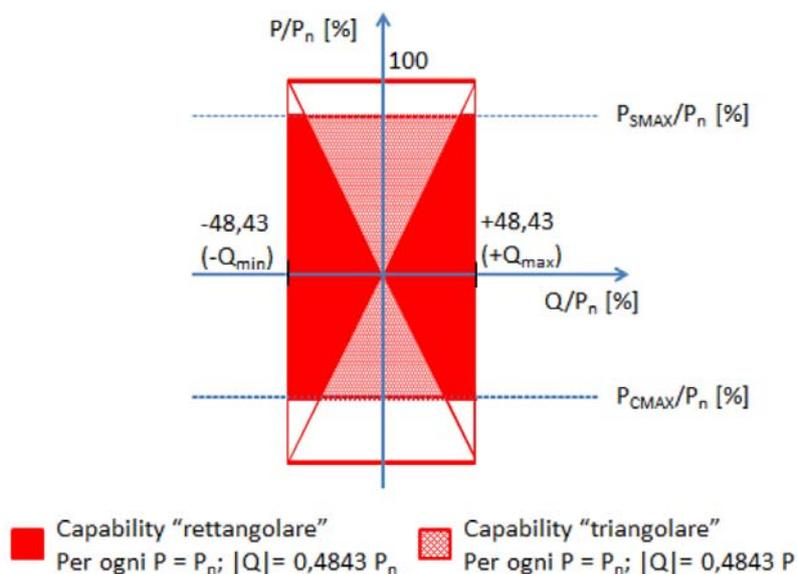
Figura 3Bbis – Capability per un sistema di accumulo con inverter bidirezionale.
