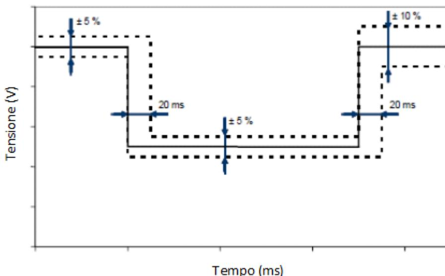
**Figura 33 –Tolleranze di ampiezza e tempo per le sequenze di prova di abbassamento della tensione di rete (VRT Test) (Fonte: norma IEC 61400-21)**
