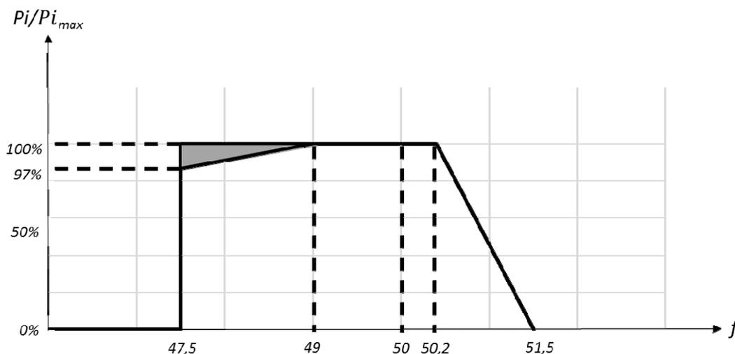
Figura 40 – Curva di riduzione della potenza attiva in sovrافrequenza
