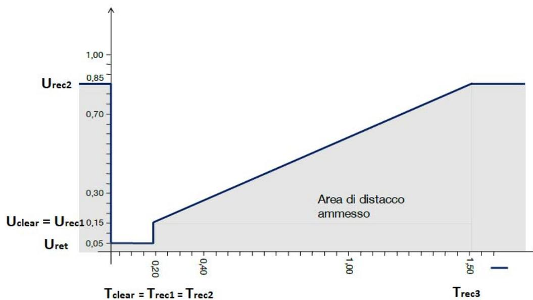
**Figura 14b - Profilo di fault-ride-through dei parchi di generazione oltre 11,08kW**
