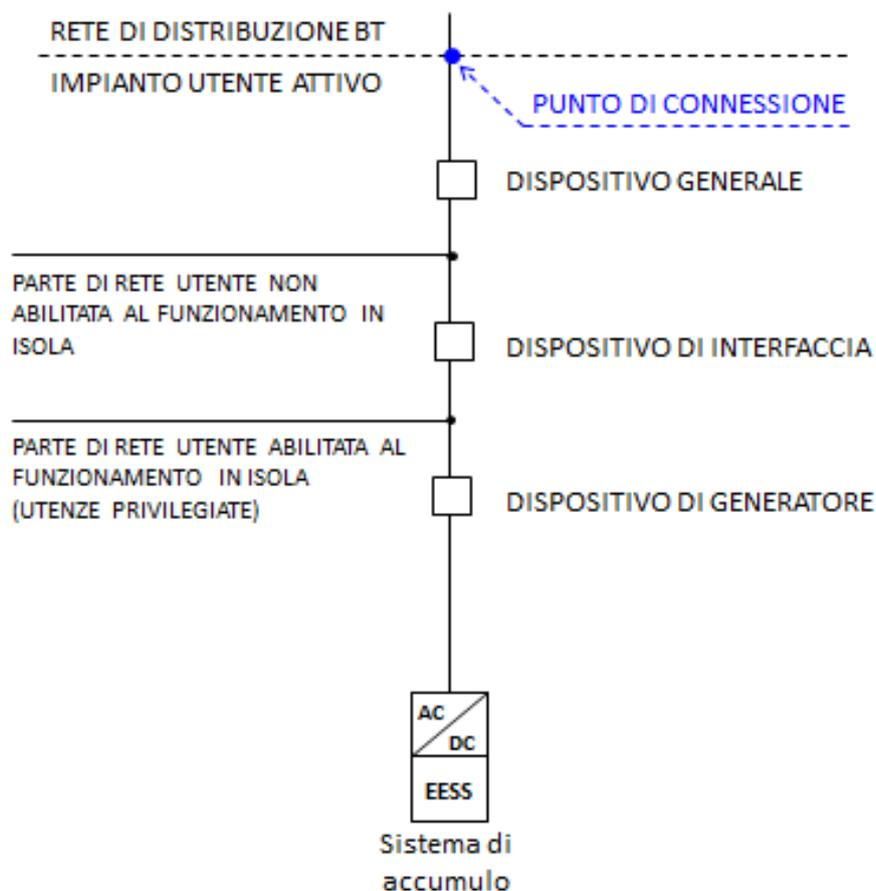
**Figura 11e – Utente con sistema di accumulo**
