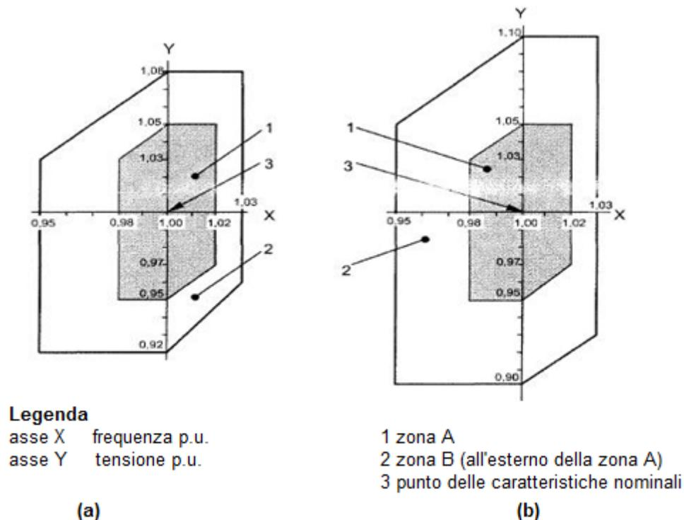
**Figura 12ter – Valori limiti di tensione e frequenza per generatori sincroni (a) e asincroni (b).**
