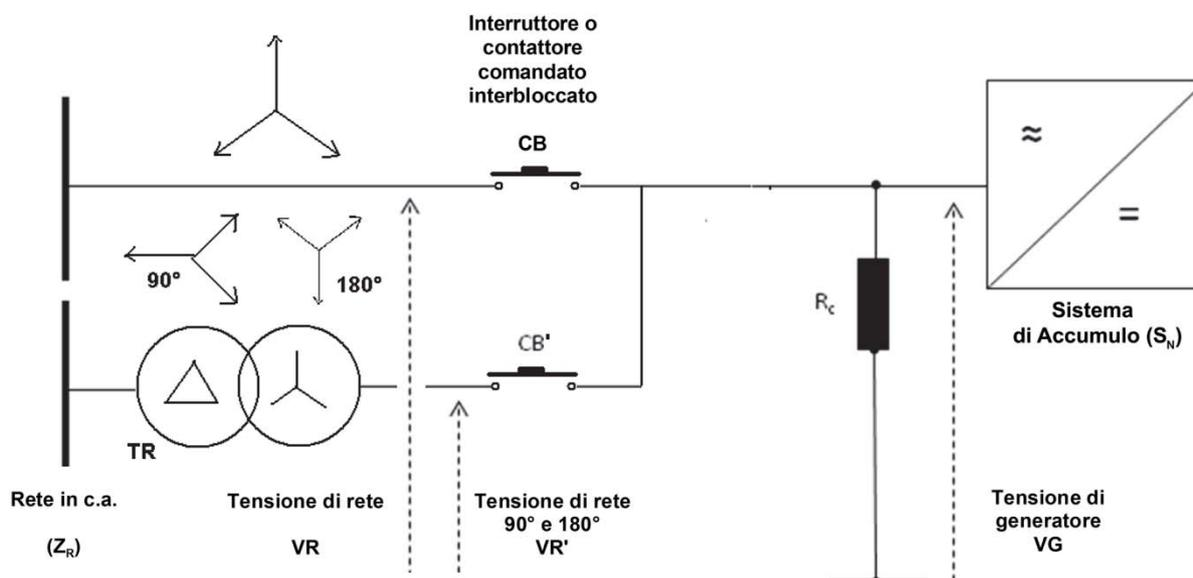
**Figura 17Bbis – Circuito per la verifica della insensibilità alla richiusura automatica in discordanza di fase tramite trasformatore di accoppiamento**
