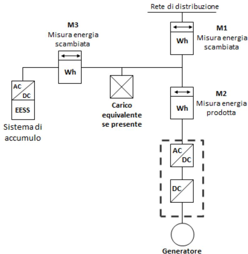
**Figura 19.3 – Misura dei flussi di energia con accumulo posizionato nella parte d’impianto in corrente alternata a monte del contatore dell’energia generata (Nota: inserimento del contatore M3 è limitato ai casi in cui corre l’obbligo dell’installazione per riconoscimento di incentivi economici)**
