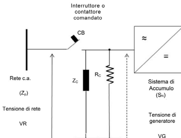
**Figura 18Bbis – Circuito per la verifica della insensibilità alla richiusura automatica in discordanza di fase. Collegamento diretto alla rete di distribuzione e simulazione della deriva di frequenza**
