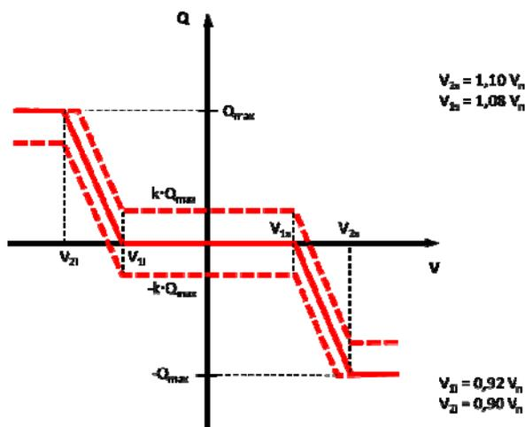
Figura 8Bbis – Curva caratteristica standard  $Q = f(V)$
