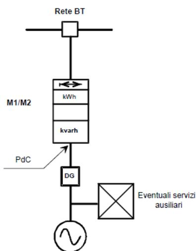
**Figura 18 – Schema di collegamento dei sistemi di misura per i punti di immissione riferiti a impianti di produzione per i quali l'energia elettrica immessa ed eventualmente prelevata coincide con l'energia elettrica prodotta al netto di eventuali servizi ausiliari**
