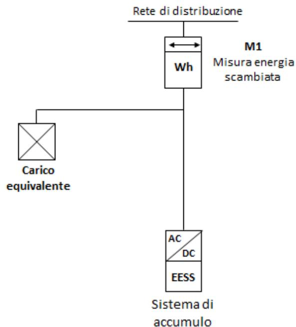
**Figura 19.4 – Utente con sistema di accumulo**
