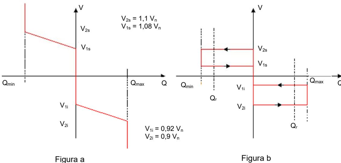
Figura 28 – Curve caratteristiche standard  $Q = f(V)$
