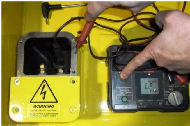
Esempio di controllo dell'isolamento verso massa un sollevatore elettromagnetico. Le misure elettriche devono essere **SEMPRE** effettuate con il sollevatore scollegato dall'impianto d'alimentazione, da persona competente.
