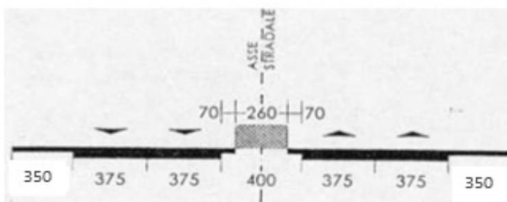
Sezione indicativa, non comprensiva degli spazi laterali di completamento e protezione della sede stradale, da verificare con la vigente normativa
