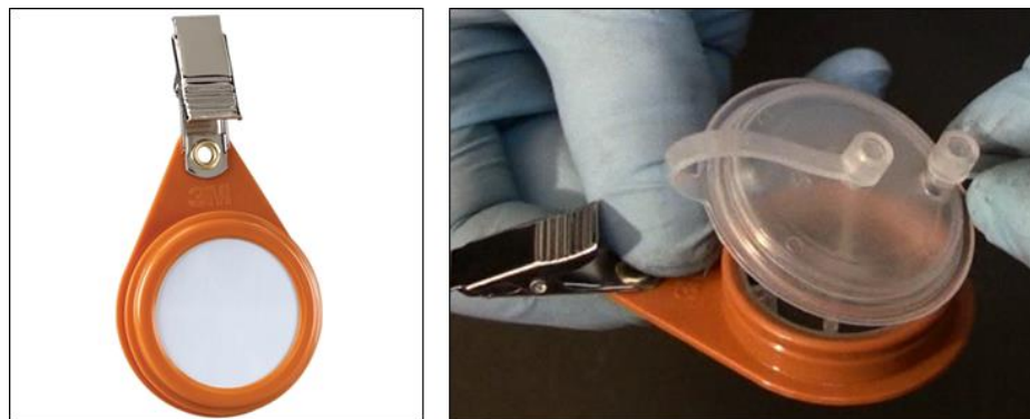
Figura 8 – Campionatore 3M OVM 3500 TM e tappo di plastica utilizzato per sostituire il materiale poroso dopo il campionamento
