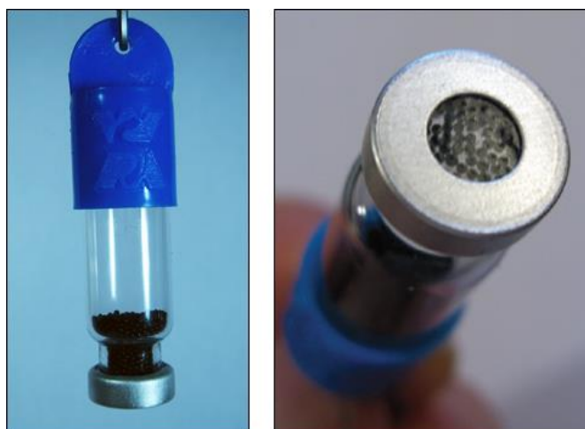
Figura 11 – Campionatore Water Membrane Sampler TM caratterizzato dall'utilizzo di un tappo con membrana in polidimetilsilossano (SIREM)
