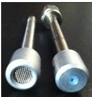
Figura 10 – Campionatori ATD tube a flusso regolare (sinistra) o a basso flusso (destra)
