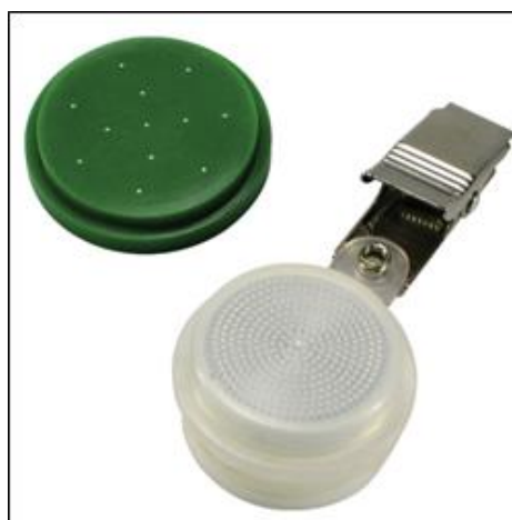
Figura 9 – Campionatore SKC TM Ultra a flusso regolare (tappo bianco) e a basso flusso (tappo verde)
