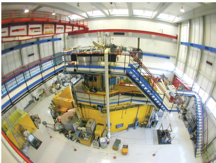
L'asportazione della potenza termica prodotta dal nocciolo viene effettuata per circolazione naturale di acqua. L'acqua della piscina, a cui tale potenza viene ceduta, viene mantenuta a temperatura costante per mezzo di un apposito circuito di raffreddamento munito di scambiatori di calore e di torri di refrigerazione.
