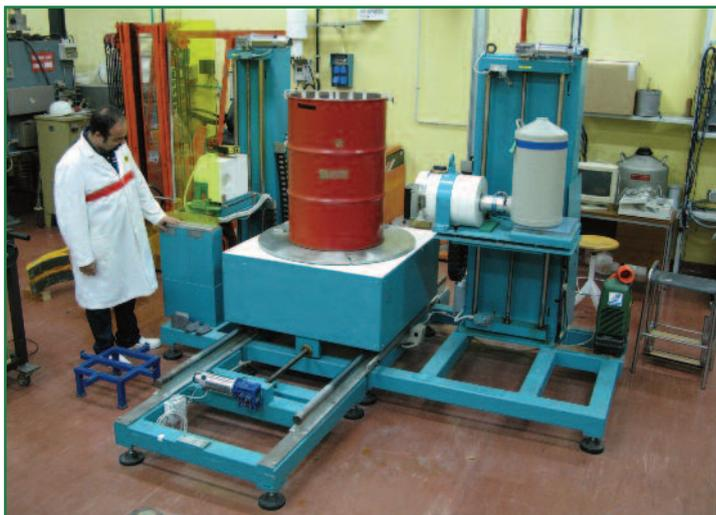
**ISOCS (In Situ Object Counting System)** è uno strumento da campo che permette la misura quantitativa di radionuclidi  $\gamma$ -emettitori contenuti in campioni di varia forma e natura. Il sistema ISOCS è costituito da:
