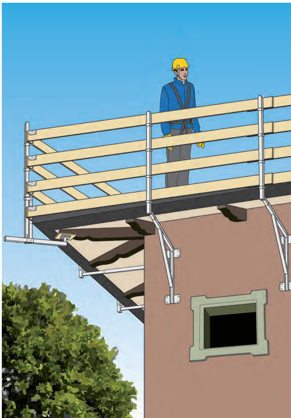
Figura 6 - Parapetto provvisorio con gancio sottocoppo
