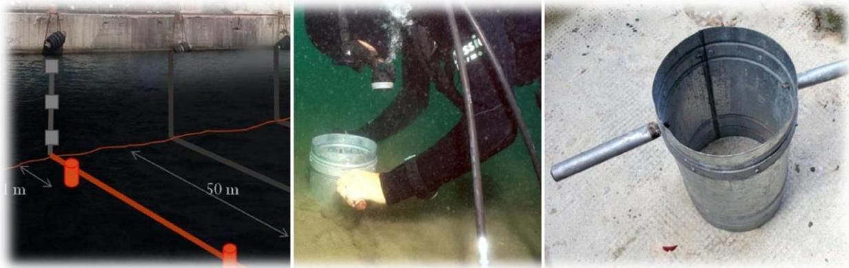
**Figura A4-** Campionamento di infauna su transetto orizzontale utilizzando un carotiere a mano ( $\varnothing = 18 \text{ cm}$ ,  $h = 30 \text{ cm}$ ).
