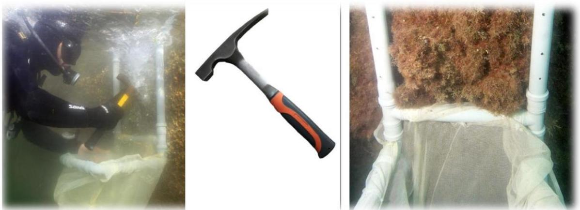
**Figura A3** - Attività di campionamento subacqueo con scalpello e rettangolo di campionamento.
