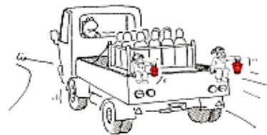
Pertanto, quando ad esempio un tecnico Linde trasporta una piccola bombola di un gas che impiegherà per la taratura degli strumenti di misura o per l'effettuazione di prove presso il cliente, è sufficiente che siano rispettate le regole di sicurezza generali (regole di carico e scarico delle bombole, fissaggio del carico, ventilazione del veicolo, divieto di fumare e di usare fiamme libere, sosta in condizioni di sicurezza).
