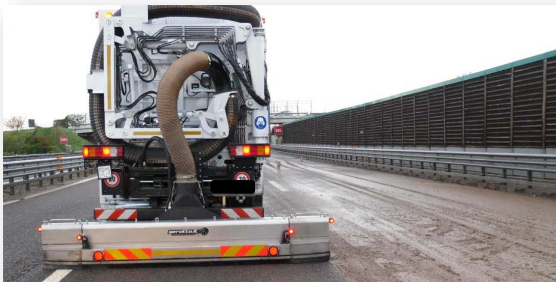
**Figura 15 - Lavaggio strade con barra ad alta pressione**
