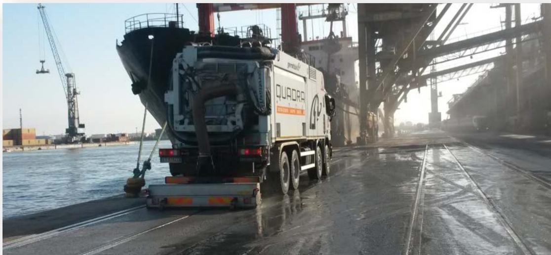
**Figura 14 - Lavaggio banchine con barra ad alta pressione**
