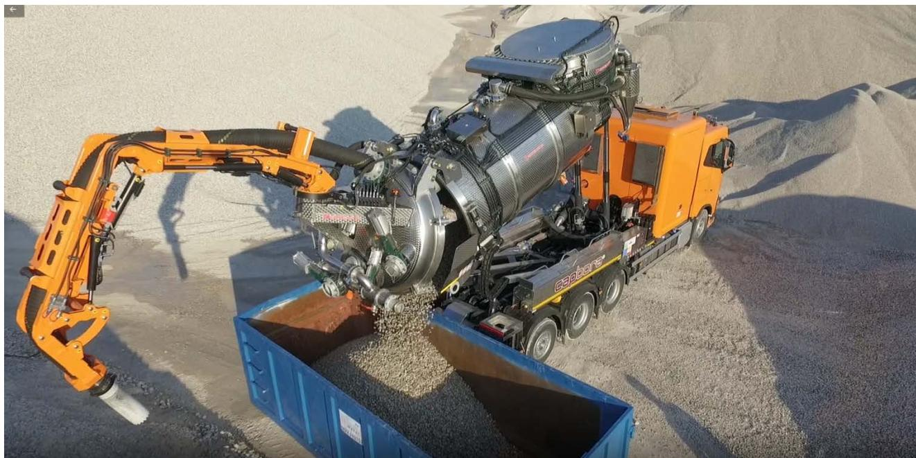
**Figura 3 - Cisterna aspirazione a pompa del vuoto**
