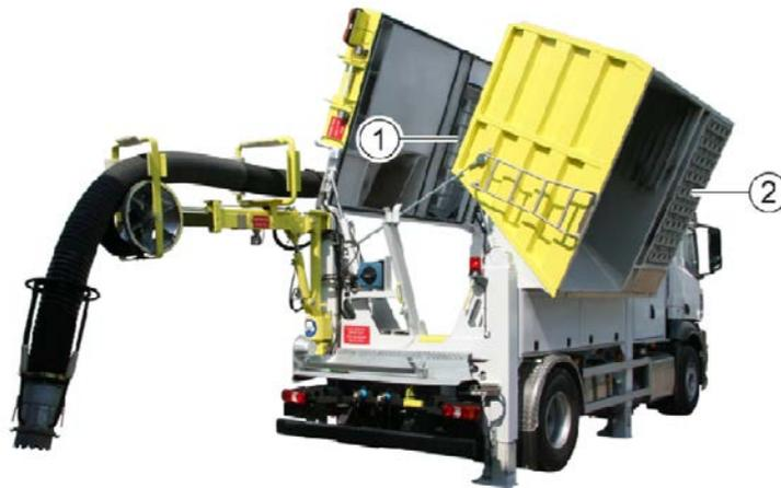
**Figura 2 - Particolare ugelli di scarico per pulizia filtri e filtri a cartuccia su allestimento a turbine**
